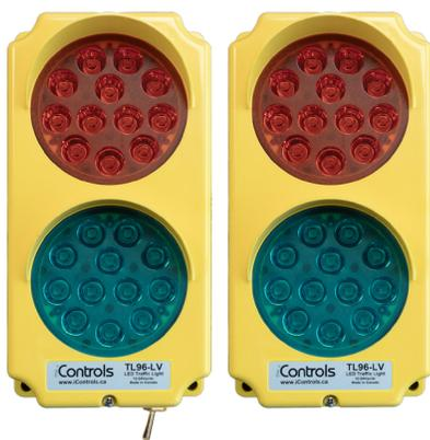
Feux à DEL Arrêt/Départ muraux intérieurs et extérieurs (série TL96) fournis pour une communication manuelle de base entre l'intérieur et l'extérieur d'un quai de chargement. L'unité de commande (intérieure) est dotée d'un interrupteur à bascule pour alterner entre les feux rouges et verts. Également disponible sans interrupteur à bascule pour une utilisation avec un détecteur de proximité ou un interrupteur de fin de course 24 Vcc (contactez iControls pour plus de détails).
