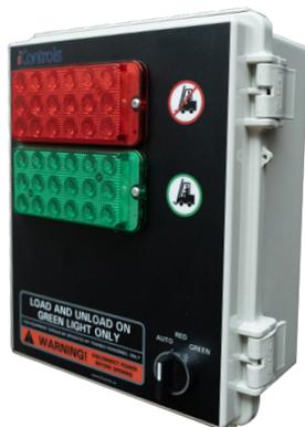
Un panneau de commande mural avec feux rectangulaires rouges et verts au 18 DEL haute visibilité et bornes d'entrée pour un détecteur de proximité ou un interrupteur de fin de course 24 Vcc et un feu Arrêt/Départ au DEL 24 Vcc extérieur. Les feux peuvent être commutés manuellement ou contrôlés par un interrupteur connecté (non fourni) en mode « Auto ».
